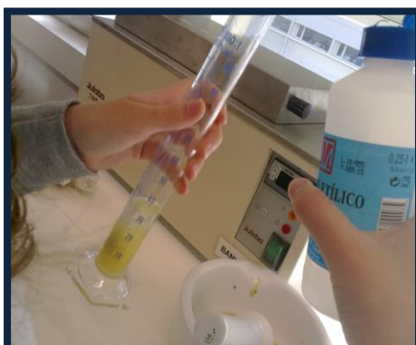
Inclinar um bocado a proveta e deitar o etanol, lentamente.
