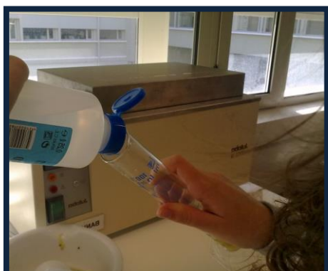
Inclinar um bocado a proveta e deitar o etanol, lentamente.
