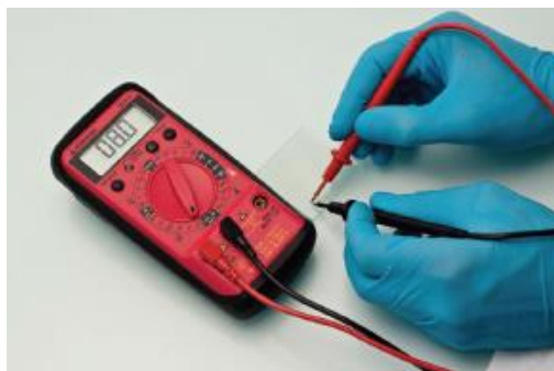
Figura 2. Identificação da face condutora dos elétrodos.
