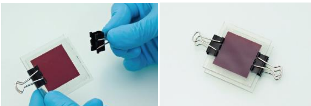
Figura 8. Fixação dos elétrodos A e B.
