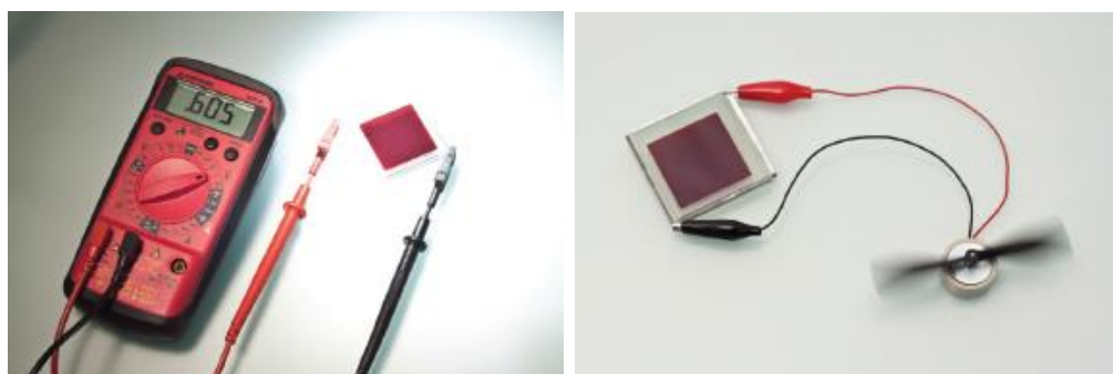
Figura 11. Teste da DSC sob iluminação artificial (lâmpada de 100 W).
